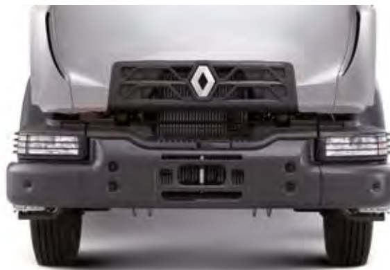
ALL STEEL BUMPER (D) for intensive use.
